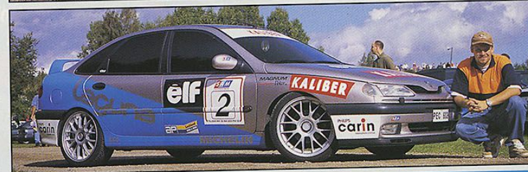
DUKTIGT SÄNKT. På Vallkärrsträffen var den här Lagunan diskret grå. Nu ser den ut att vara på rymmen från BTCC-banorna. "Dekortrimningen" har verkligen tuffat till Joachim Carléns V6-bestyckade Renault. De 170 hästkrafterna behövs för att dra runt de feta 18-tumshjulen. Extremt sänkt fjädring (minst 13 cm!) från Renault Sport fullbordar raceestet.
