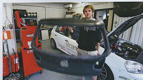
I JTCC dras VW Golfen med för mycket vikt och Richard har sökt dispens för en lättare baklucka i kolfiber. Det är tillåtet för exempelvis Seat Leon. Luckan är redan inhandlad och väger inte många kilo.
