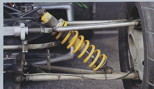
Dämparen måste vara antingen original Bilstein eller justerbar Spax. Fjädringen är fri. Robert Helling körde med Öhlins 2008.
