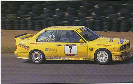
HIGHSPEED BMW. Årets SSK-mästare kör en BMW M3 med Volvo-motor på 2.023 cc — byggd av Highspeed Racing. Kombinationen BMW/Volvo är vanlig i SSK. Reglementet tillåter mycket fantasi och egna konstruktioner.
