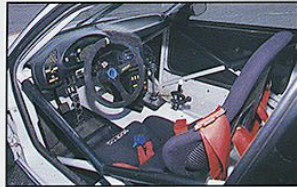
OMBONAT? Inte direkt. I mitt spaken till Hollinger växellådan som till i år har konverterats för sekventiell växling. Gör bilen mera lättkörd och spar tid (samt är roligare).
