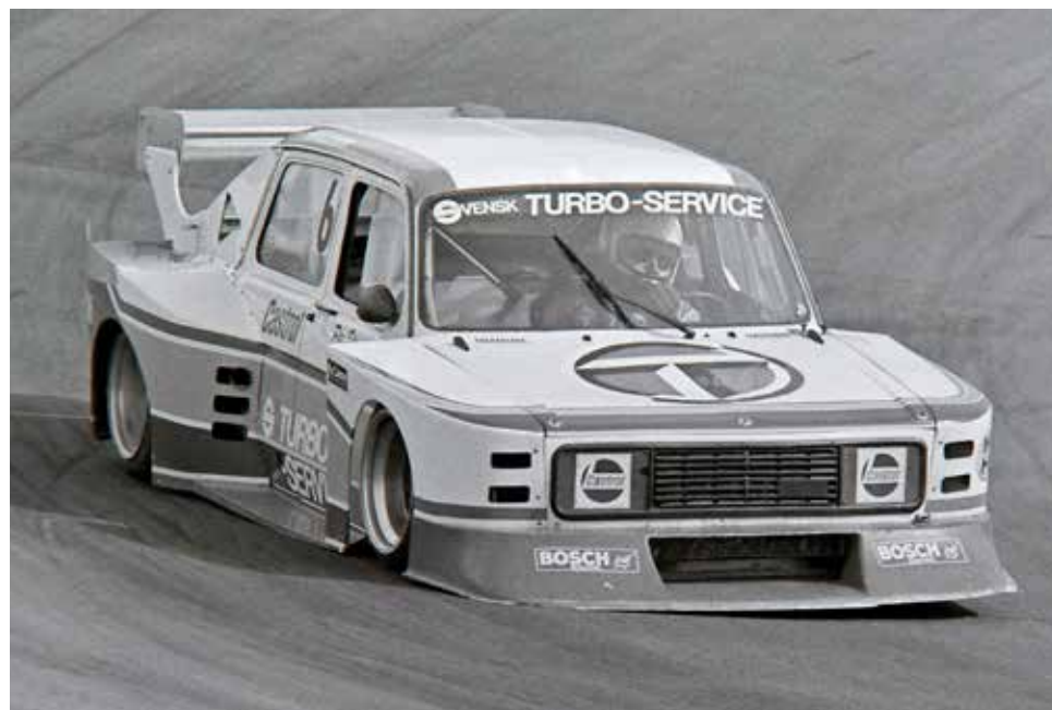
► Ett extremt Talbot-bygge på alla sätt. Ur 1100 kubik lockades med turbons hjälp runt 300 hästar fram.
